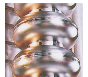
Beschleunigt Teilchen: Hochfrequenzresonator aus Niob Foto DESY
